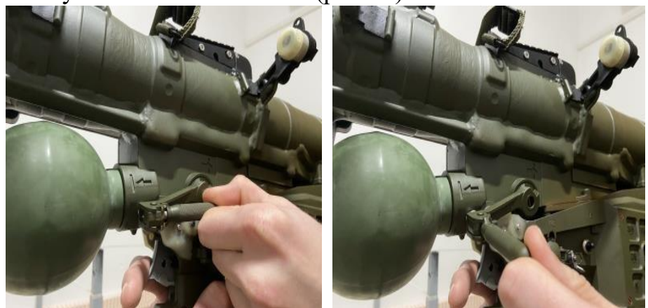
Рис. 11 – Переведення рычага наколу в бойове положення
