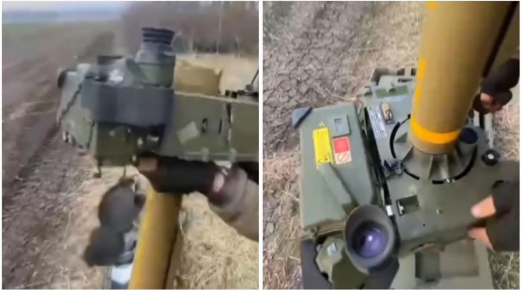
Рисунок 2.14 – Під'єднання ракети до пускового пристрою
