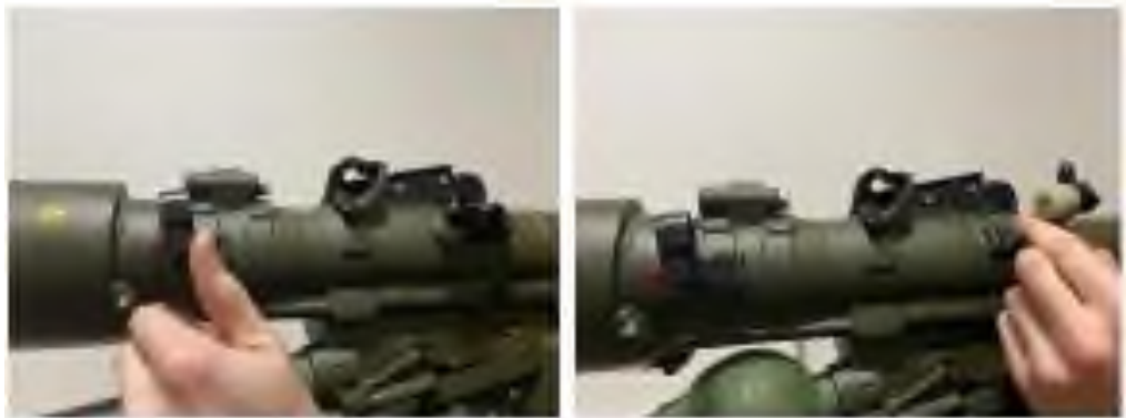
Рисунок 4.10 – Розкладання механічного прицілу
