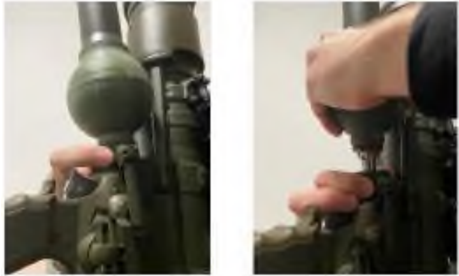
Рисунок 4.18 – Заміна блока живлення
