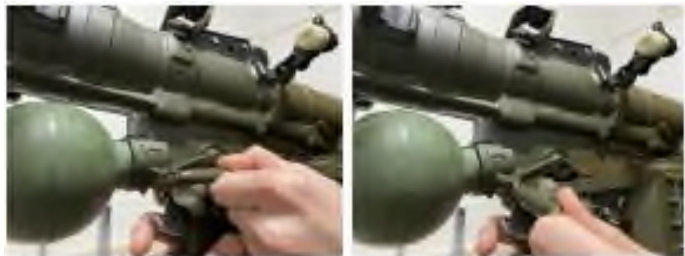
Рисунок 4.11 – Переведення важеля наколу в бойове положення
