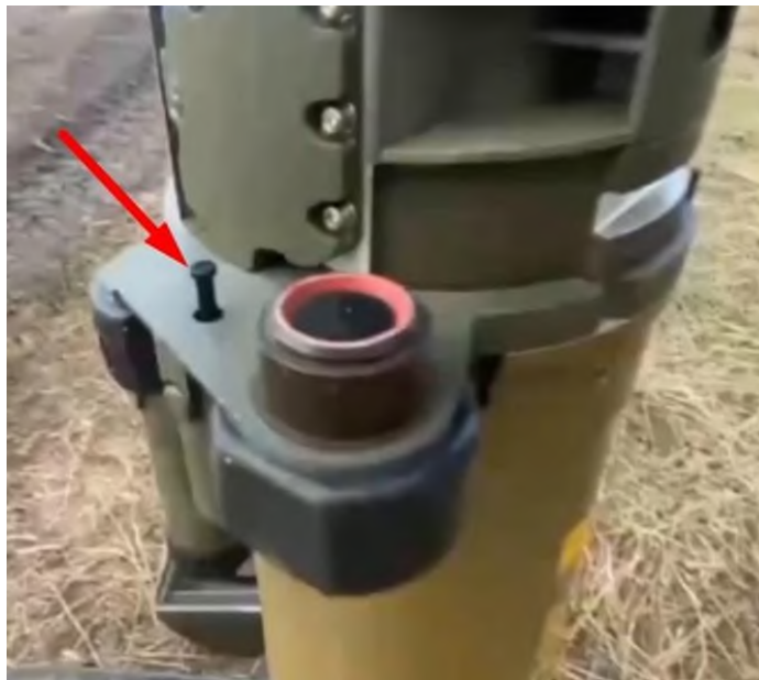
Рисунок 2.6 – Пристрій для виведення зайвого повітря
