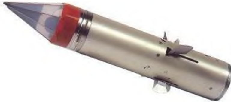
Рисунок 1.5 – Блок ГСН з автопілотом та рульовим управлінням
