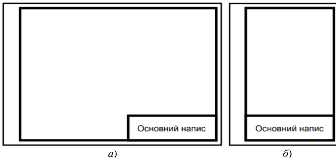
Рисунок 1.3 – Приклад розташування основного напису на різних форматах a) – усі формати, окрім А4; б) – формат А4
