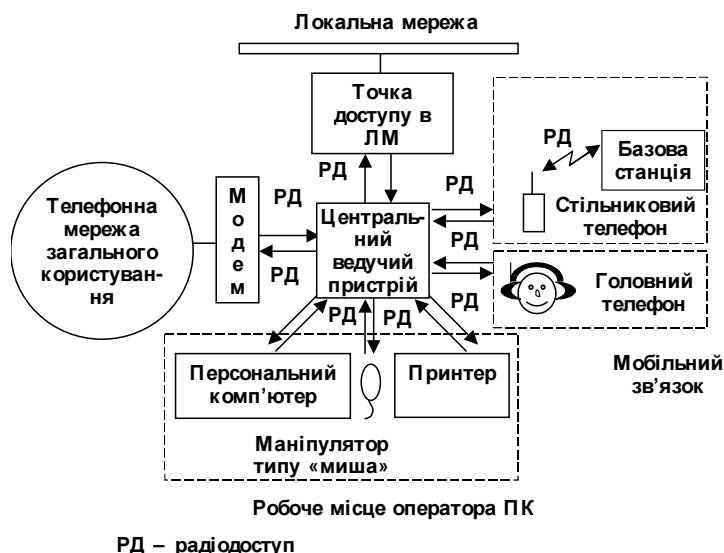
Рис. 6.19. Варіант організації абонентського радіодоступу в окремому приміщенні
