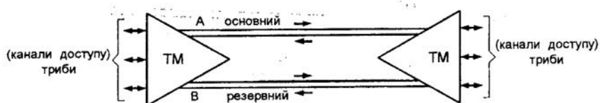
Рисунок 7.9 – Топологія „точка – точка” з використанням ТМ
