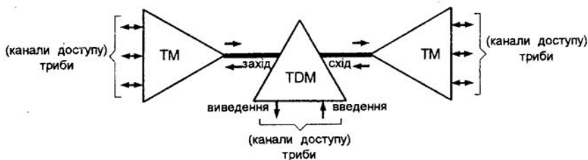
Рисунок 7.10 – Топологія „послідовне лінійне коло” на ТМ і TDM
