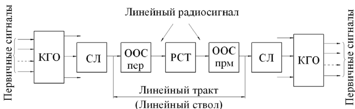
Рис. 6.1. Структурная схема радиосистемы связи
