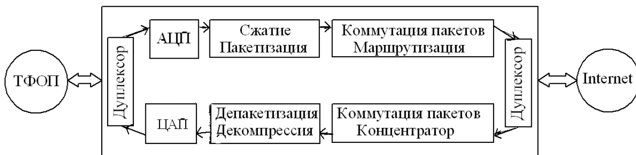
Рис. 10.3. Функциональная схема шлюза
