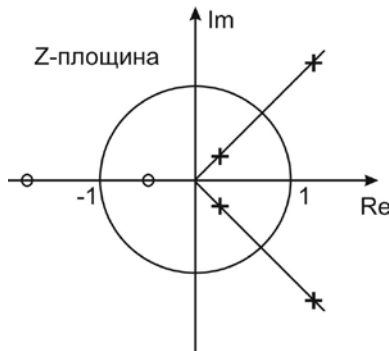
Рис. 13.1. Симетрія нулів і полюсів шуканої системи
