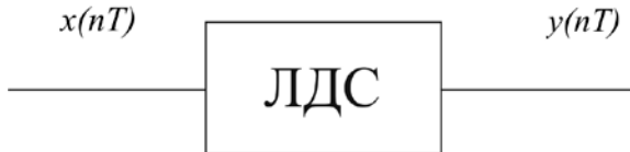
Рис. 4.1. Загальна схема обробки сигналів лінійною дискретною системою.
