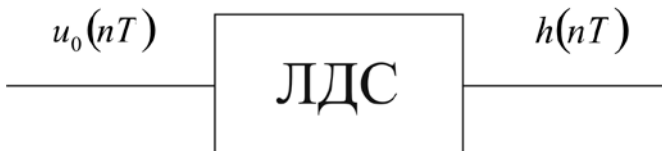
Рис. 4.2. До визначення імпульсної характеристики
