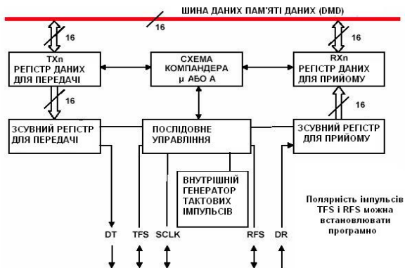
Рис. 8.8. Структурна схема послідовного порту процесора сімейства ADSP-21xx
