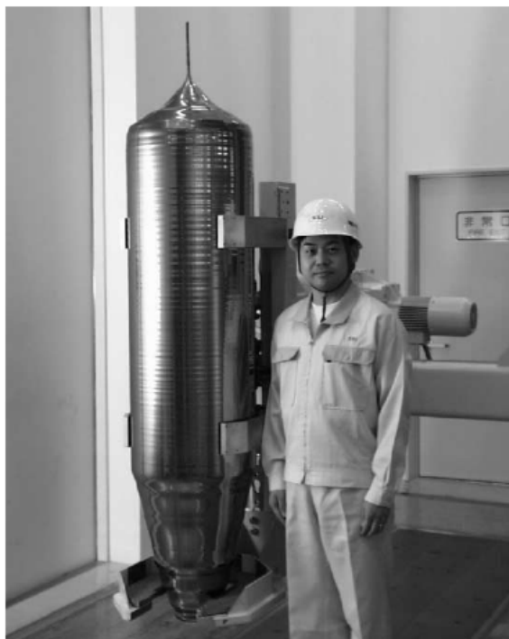
Рисунок 3.12 – Монокристал кремнію діаметром 400 мм і довжиною 1,1 м, вирощений за методом Чохральського
