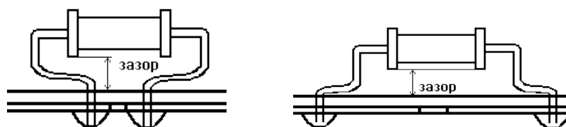
Рисунок 6.11 – Способи монтажу резисторів над друкованою платою
