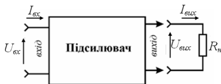
Рис. 13.1.2. Підсилювач електричних сигналів як
