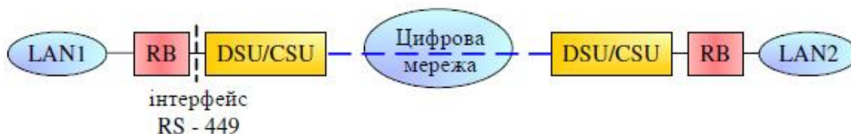
Рис.102 – Схема віддаленого доступу «мережа-мережа»
