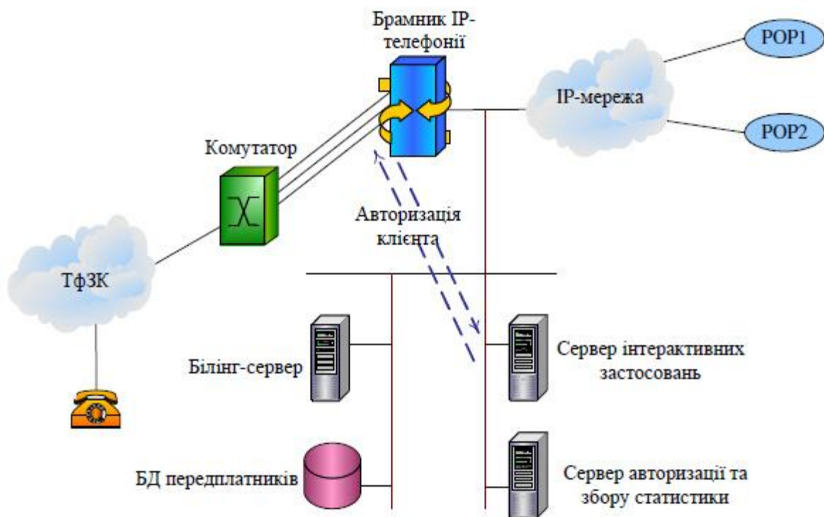
Рис. 109 – Схема міжоператорської взаємодії в IP-телефонії
