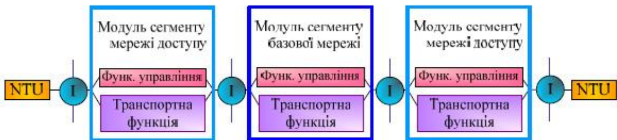
Рис. 19 – Зразок утворення транспортної підсистеми на рівні функціональної моделі I (еталонна точка телекомунікаційної мережі); NTU мережеве закінчення I – інтерфейс (еталонна точка телекомунікаційної мережі); NTU – мережеве закінчення.
