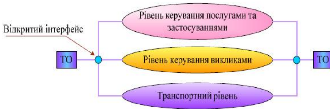
Рис. 62 – Багаторівнева архітектура концепції NGN
