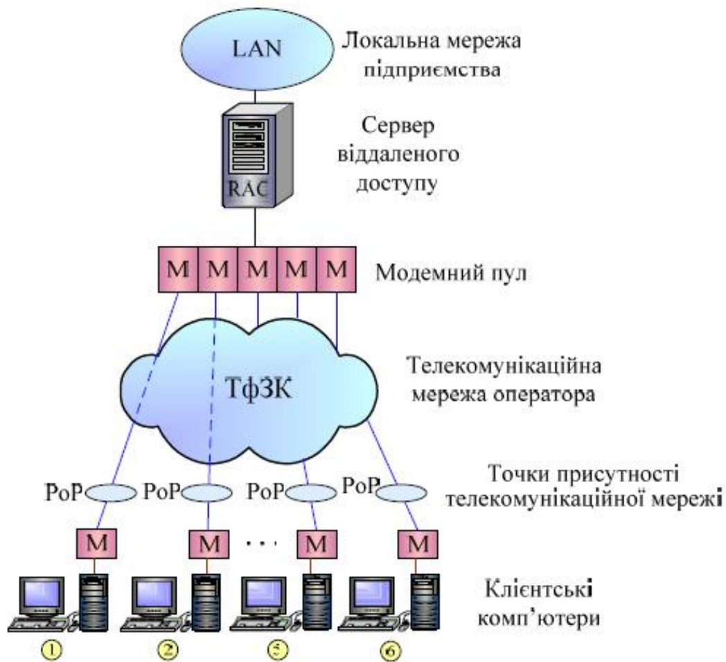
Рис.100 – Схема віддаленого доступу «комп'ютер-мережа»
