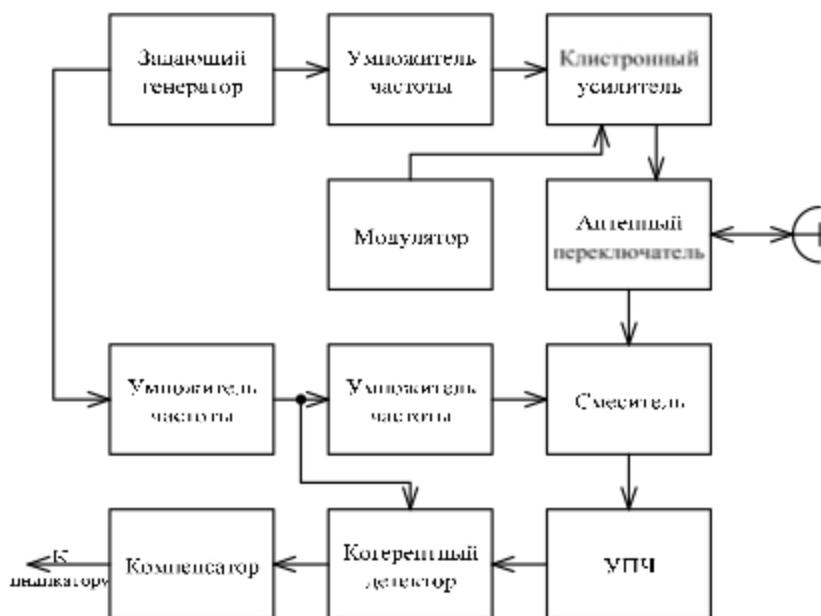
Рис. 2.13. Система СДЦ с независимым возбуждением
