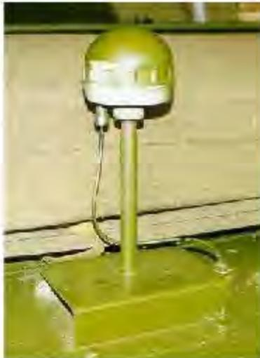
Рис. 2.47. Блок антенный
