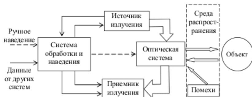
Рис. 2.36. Структурная схема ОЛС
