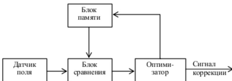
Рис. 2.5. Система экстремальной радионавигации
