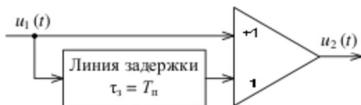
Рис. 2.15. Череспериодный компенсатор
