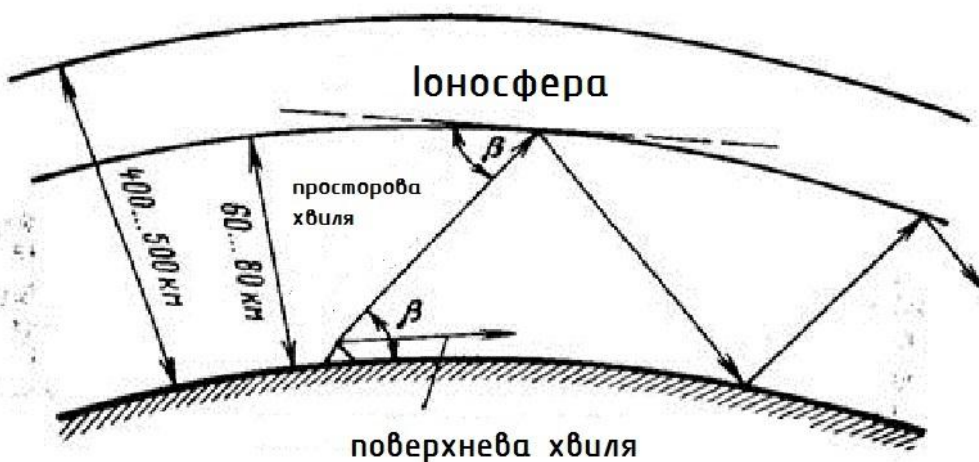
Рис.1.1.розповсюдження просторової та поверхневої хвиль
