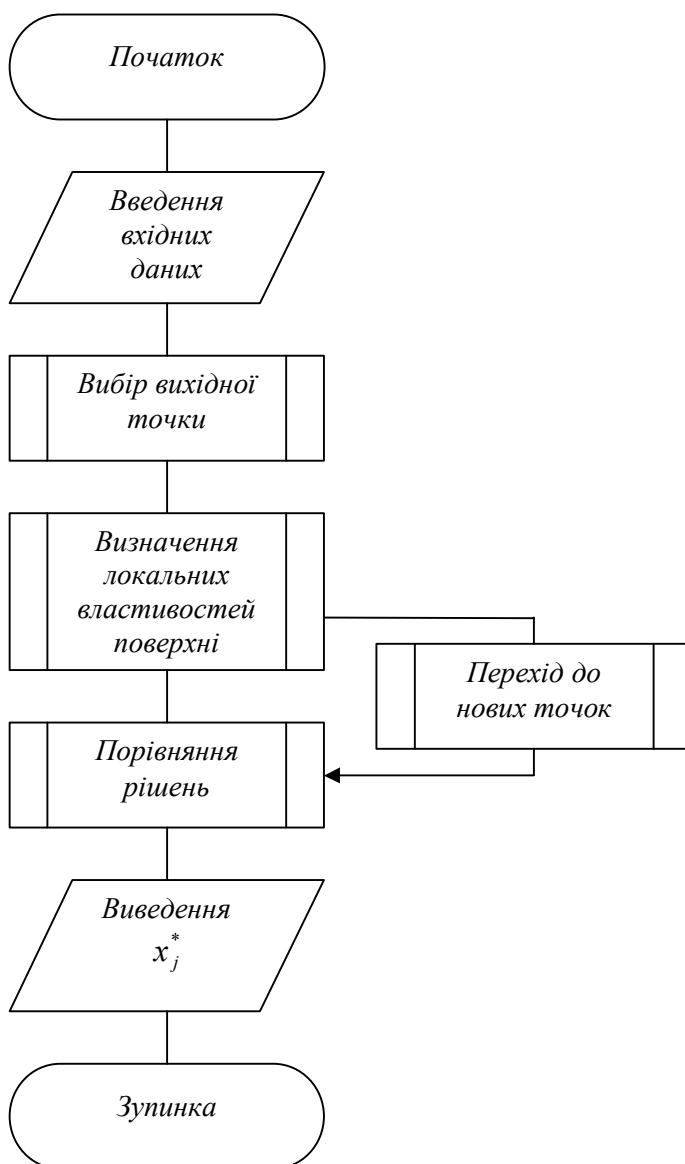
Рис. 3.6. Алгоритм організації автоматизованого процесу оптимізації.
