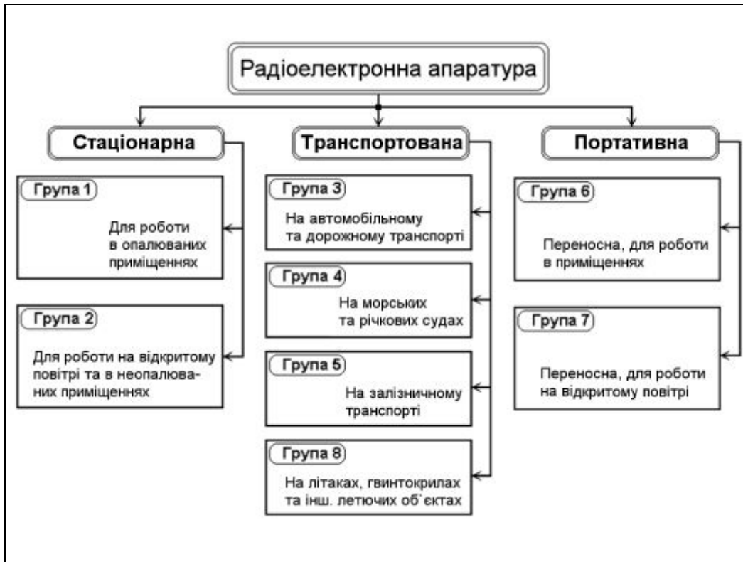
Рис.2.1. Класифікація апаратури за умовами експлуатації.
