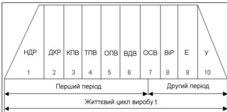
Рис. 1.1. Структура життєвого циклу виробу.
