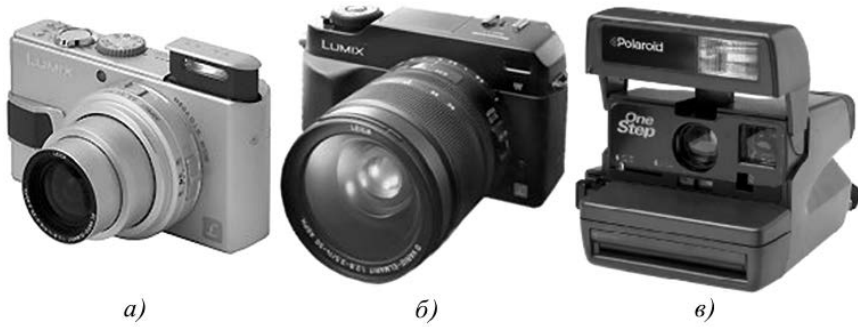
Рисунок 1.1. Пристрої оптико-механічної реєстрації нерухомих зображень: а, б – цифрові аматорський та професійний фотоапарати компанії Panasonic, в – фотоапарат компанії Polaroid для миттєвого виготовлення фотознімка
