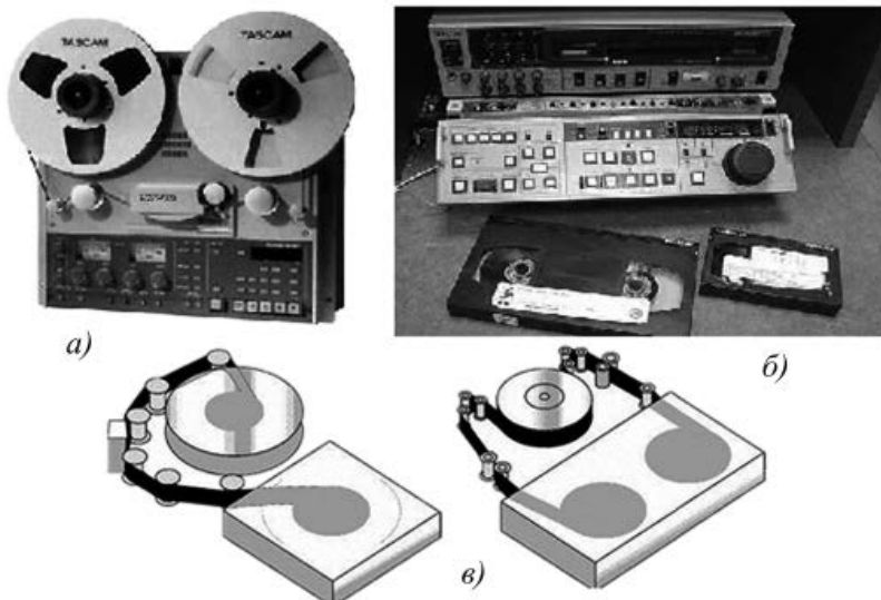
Рисунок 1.5. Пристрої для електромагнітної реєстрації інформації на магнітній стрічці: а – котушковий аудіомагнітофон, б – касетний відеомагнітофон, в – приклади траєкторій стрічки у стрічкопротяжних механізмах
