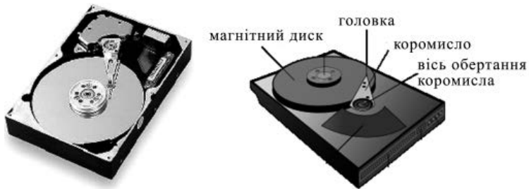
Рисунок 1.4. Пристрої для електромагнітної реєстрації інформації на магнітних дисках
