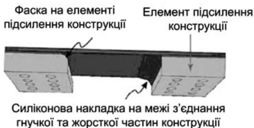
Рисунок 5.11. Конструктивні елементи для з'єднання гнучкої та жорсткої частин друкованої плати
