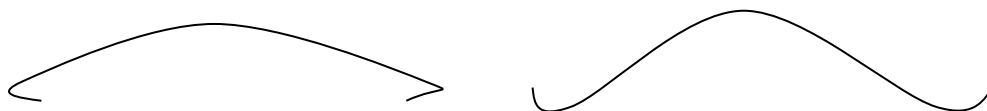
Рисунок 3.13 Сплайни, побудовані по одним і тим же визначальним точкам, але з різними напрямками дотичних у початковій та кінцевій точках
