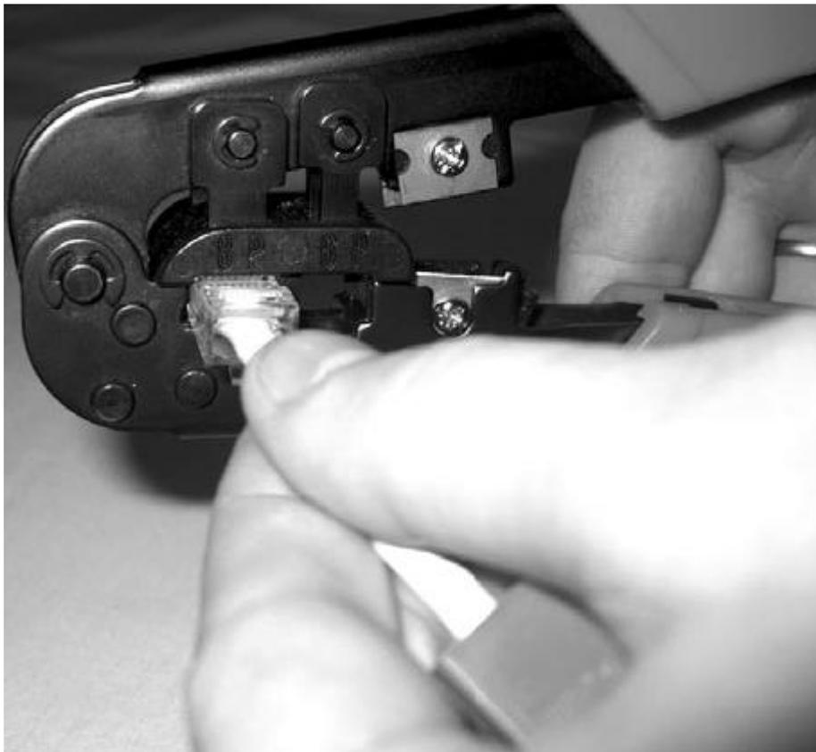
**Рис. 18.8.** Обжимаем коннектор с помощью инструмента
