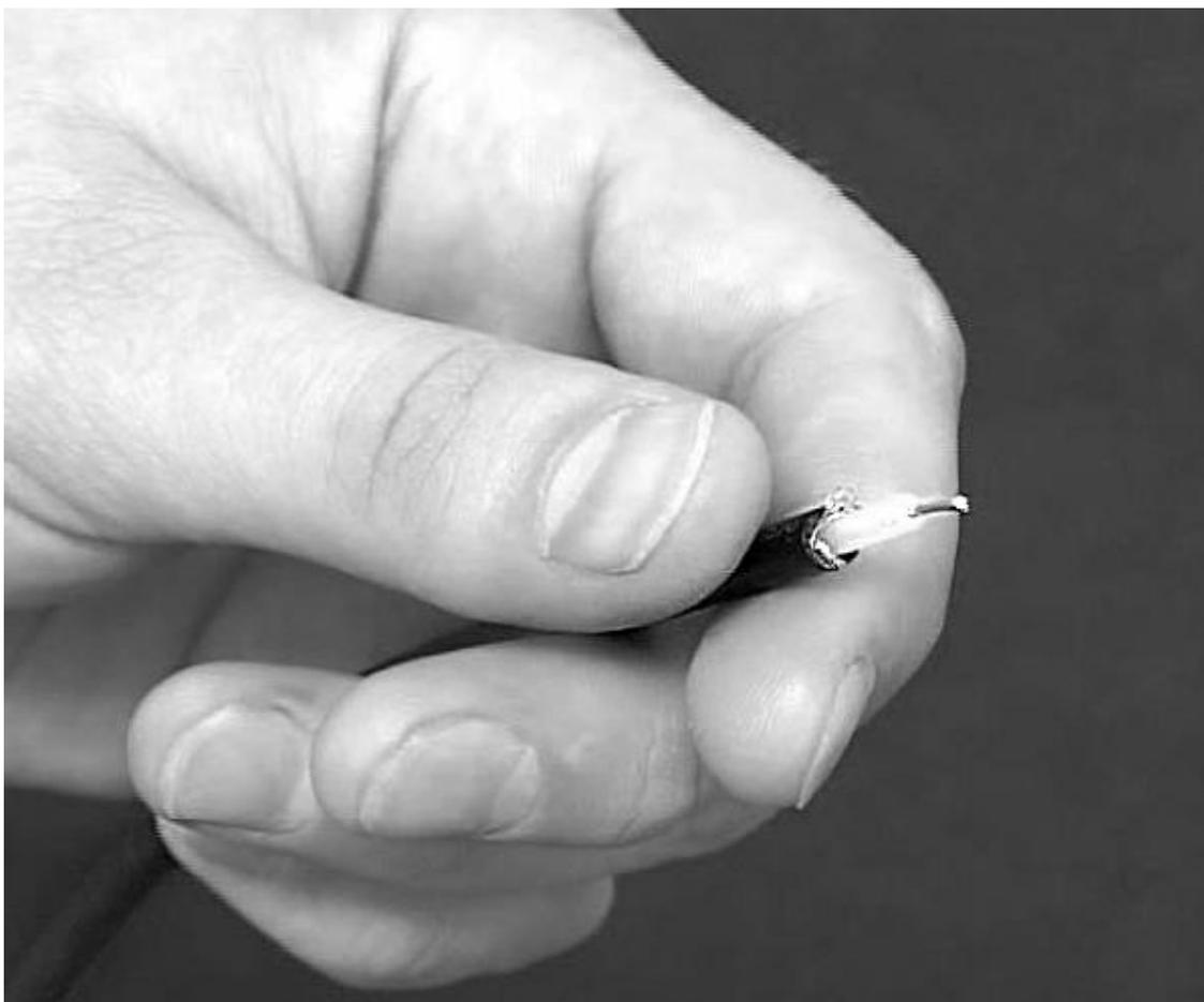
**Рис. 17.2.** Пример правильно обрезанного кабеля
