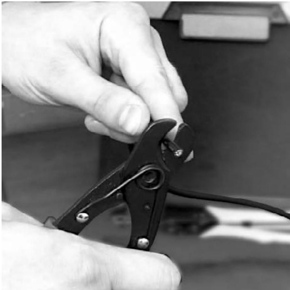
**Рис. 17.1.** Обрезка кабеля с помощью инструмента
