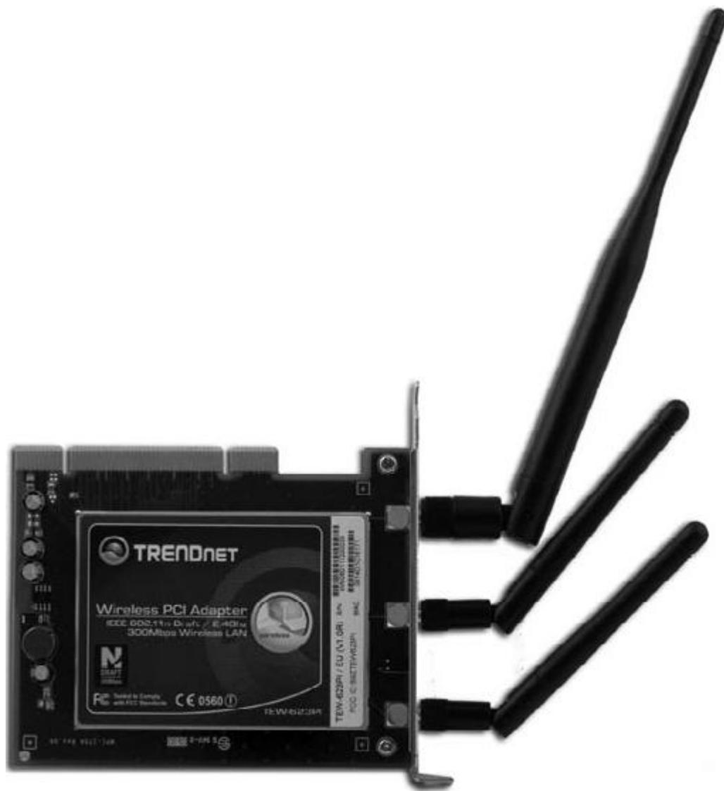
**Рис. 15.8.** Сетевой беспроводной адаптер с несколькими антеннами
