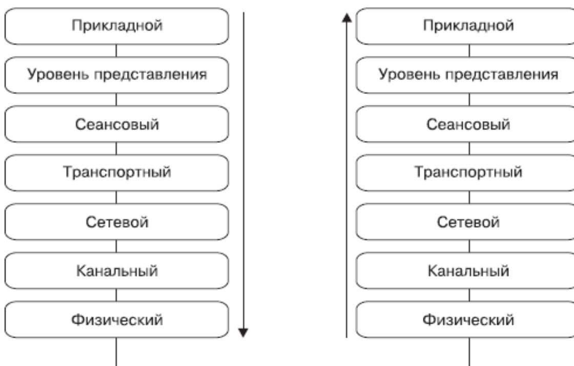
**Рис. 3.1.** Схематическое отображение модели ISO/OSI
