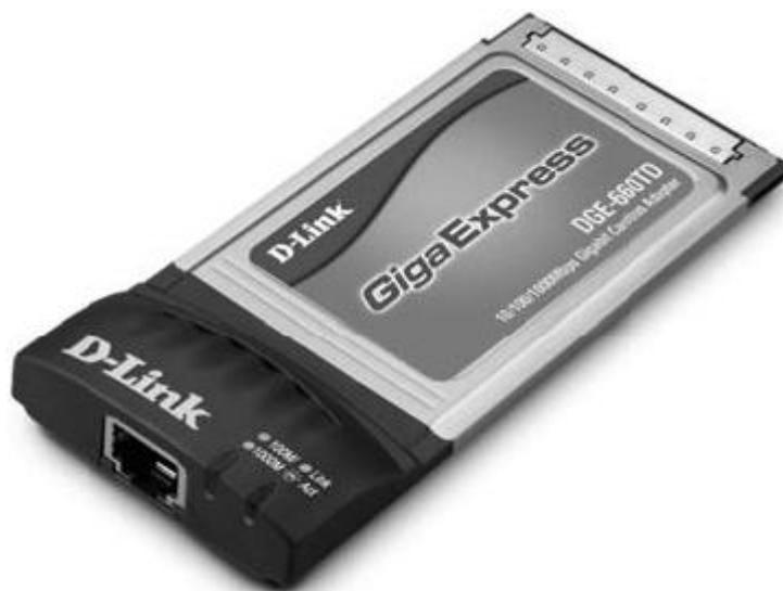
**Рис. 15.6.** Сетевой адаптер для установки в РСМСІА-порт
