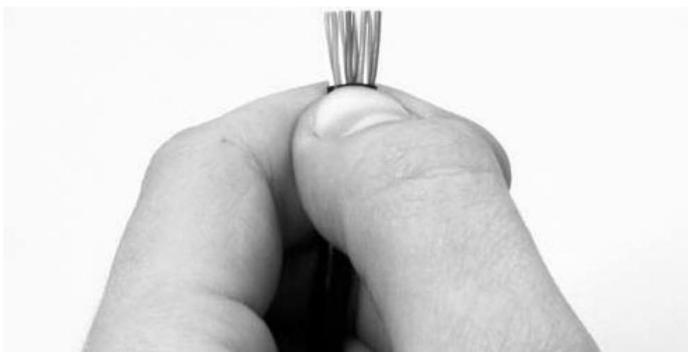
**Рис. 18.6.** Выравниваем и обрезаем проводники
