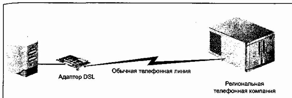
Рис. 4.13. Подключение к сети DSL
