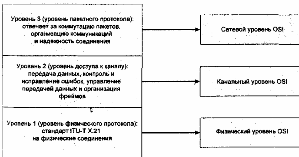
Рис. 7.1. Уровни коммуникаций X.25 в сравнении с эталонной моделью OSI
