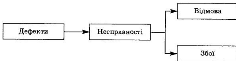
Рис. 3.1. Взаємна залежність дефектів, несправностей, збоїв і відмов
