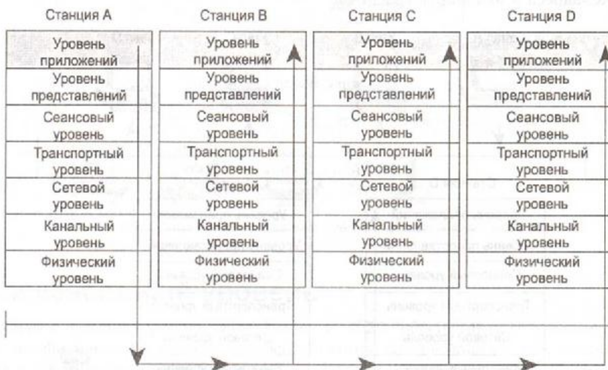
Рис. 4.6. Широковещание позволяет отправлять один кадр одновременно многим станциям, используя специальный канальный адрес пункта назначения
