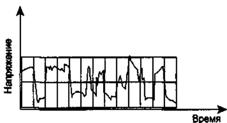
Рис. 8.16. Шум накладывается на цифровой сигнал, принимаемый компьютером
