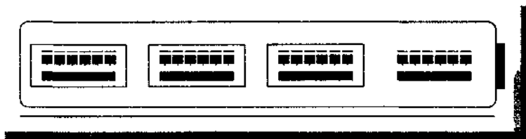
Рис 8 11 Порты размещаются на передней стенке коммутационной панели
