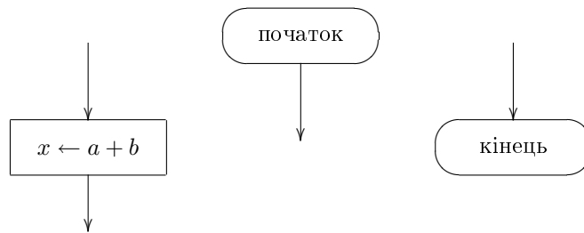
Рис. 1.2. Найпростіші позначення у блок-схемах
