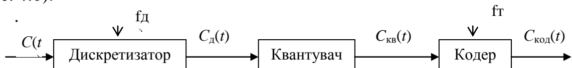
Рис. 4.6. Структурна схема аналого-цифрового перетворювача
