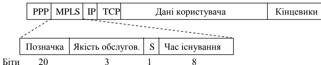
Рис. 14.4. Передавання TCP-сегмента з використанням IP, MPLS, PPP
