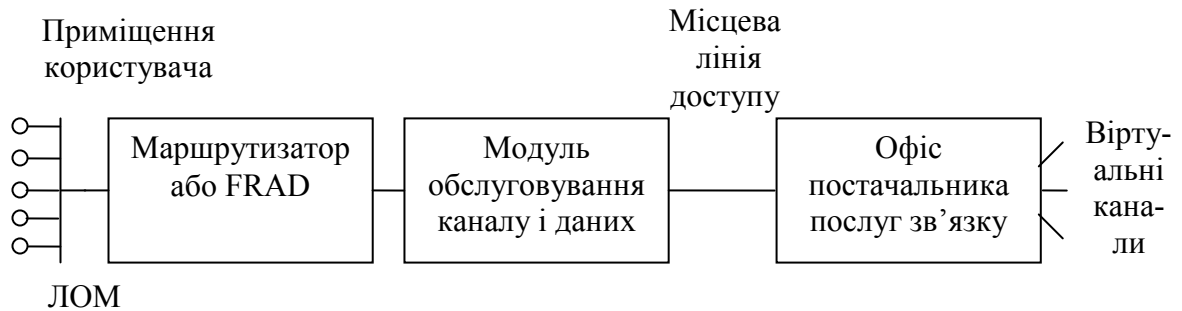
Рис. 13.4. Складові мережі Frame Relay
