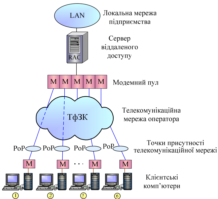
Рисунок 12.9. Схема віддаленого доступу «комп'ютер-мережа»
