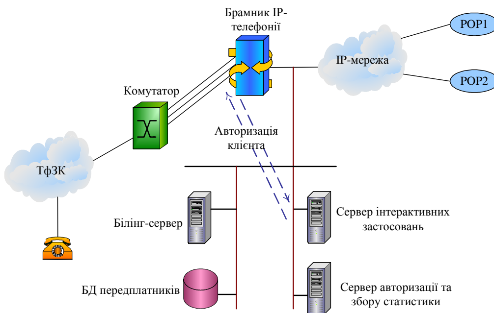
Рисунок 18.2. Схема міжоператорської взаємодії в ІР-телефонії
