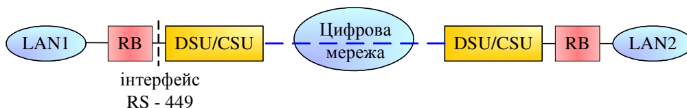
Рисунок 12.11. Схема віддаленого доступу «мережа-мережа»
