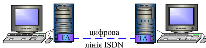
Рисунок 12.7. Під'єднання DTE до лінії ISDN ТА - термінальний адаптер
