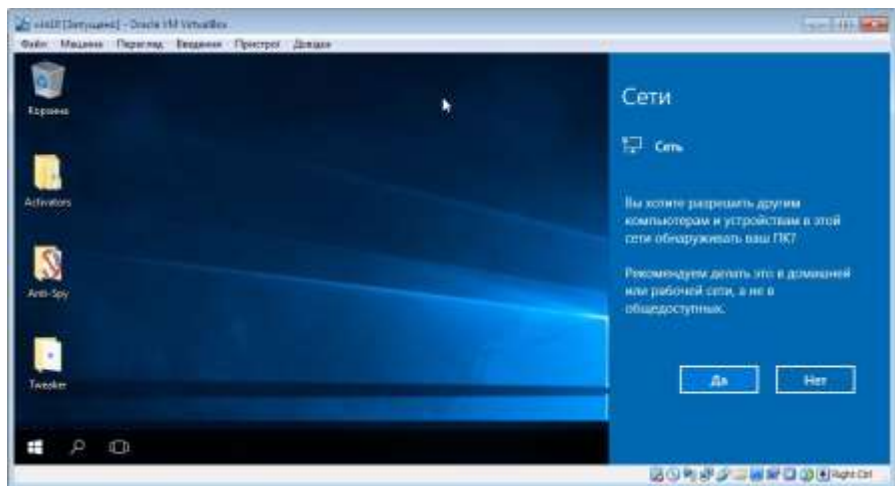
Рис. 2.18. Вибір типу мережі при встановленні ОС Windows
