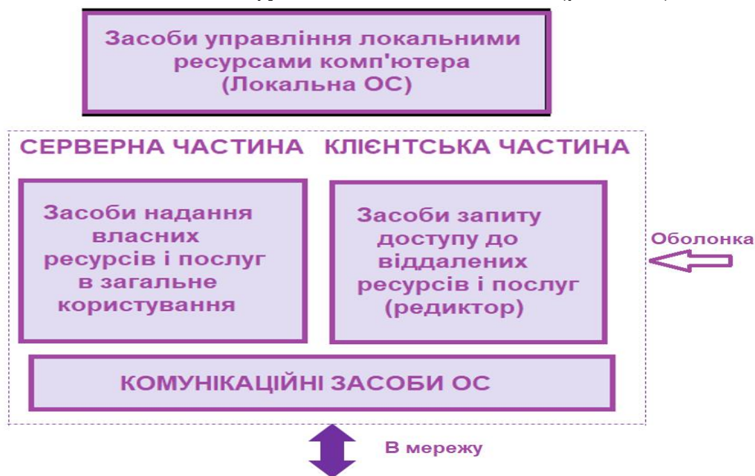
Рис. 18.1. Структурна схема мережевої операційної системи
