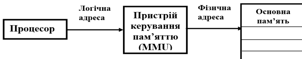
Рис. 3.3. Перетворення логічних адрес у фізичні
