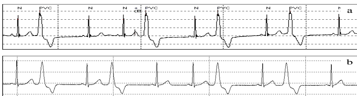
Рис. 2.21. Реальна (а) та модельна (б) ЕКГ з екстрасистолами
