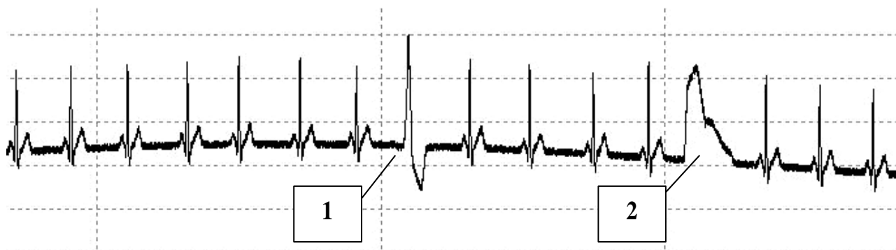
Рис. 2.12. Штучна ЕКГ з імітацією екстрасистоли (1) та артефакту (2)
