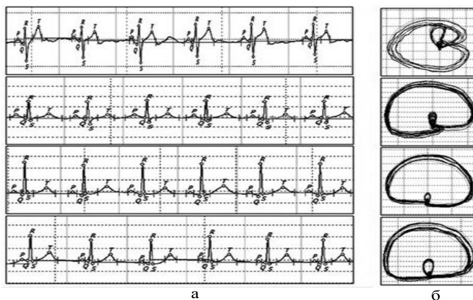
Рис. 8.3. Порівняння графічних образів чотирьох записів ЕКГ а – у часовій області, б – на фазовій площині z(t), \dot{z}(t)
