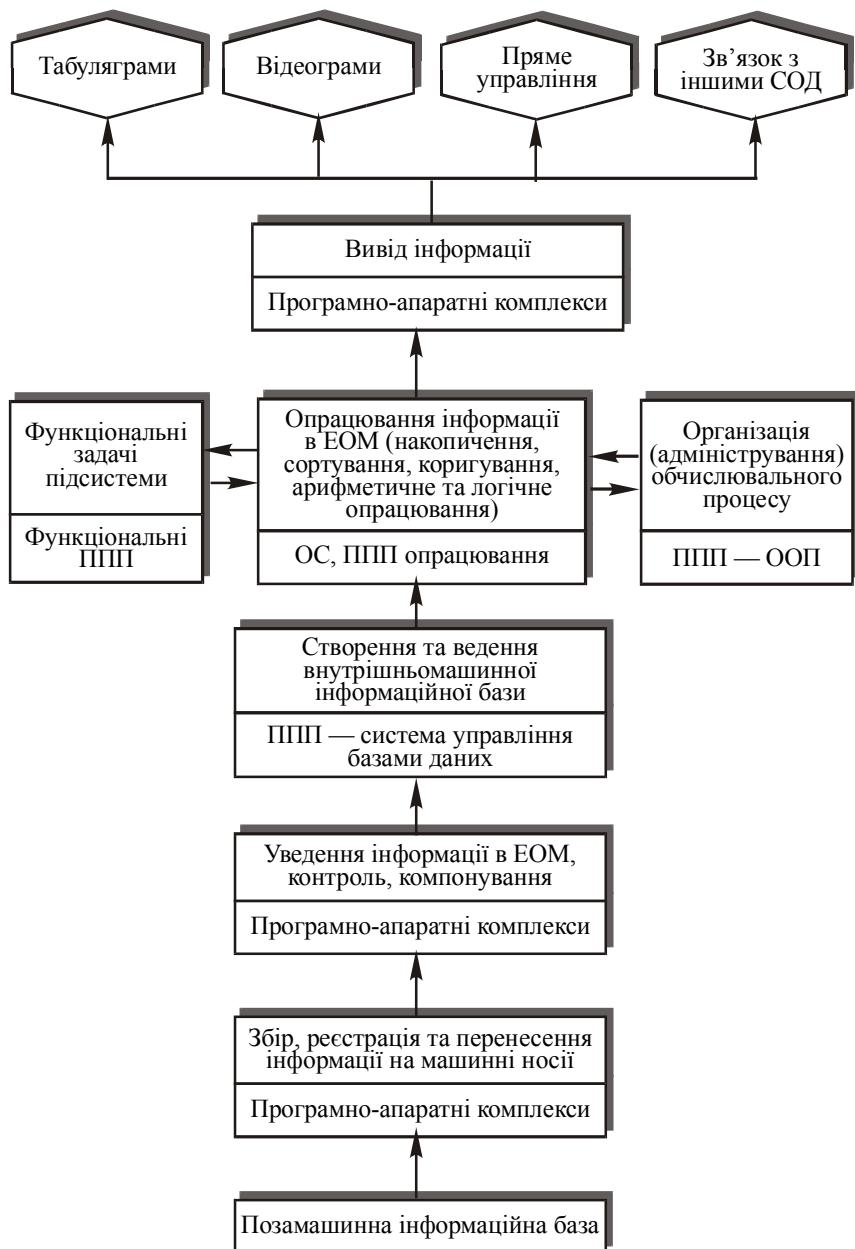
Рис. 2.3. Принципова схема системи опрацювання даних (СОД)
