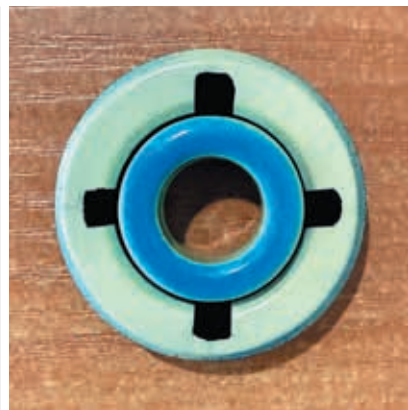
Рис. 56. Гібридне осердя з порошкового та феритового осердь
