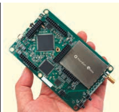
Рис. 1. Інноваційна OEM-плата Nordian та рішення PX9, що використовує GNSS-модулі ZED-F9P і NEO-D9S від u-blox
