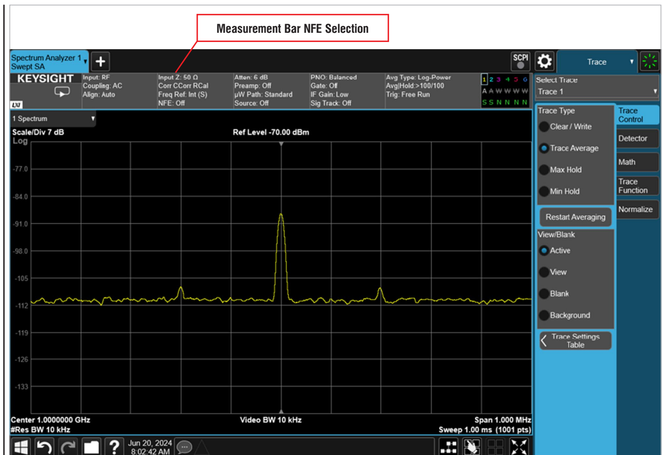
Рис. 3. Рисунок 3. Початок використання функції NFE: натисніть на третій заголовк меню на панелі вимірювань у верхній частині екрана
