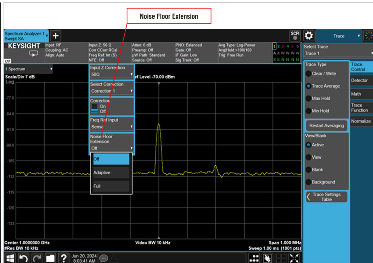
Рис. 4. Натисніть функціональну клавішу Noise Floor Extension і виберіть Adaptive або Full. Крім того, увімкніть усереднення траси з достатньою кількістю усереднень ( \geq 10 усереднень)
