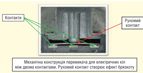
Рис. 4. Конструкція тактового перемикача
