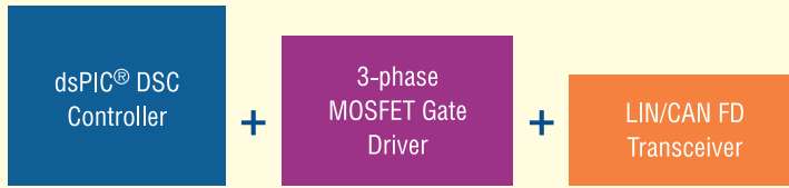
Рис. 2. Склад інтегрованого драйвера двигуна
