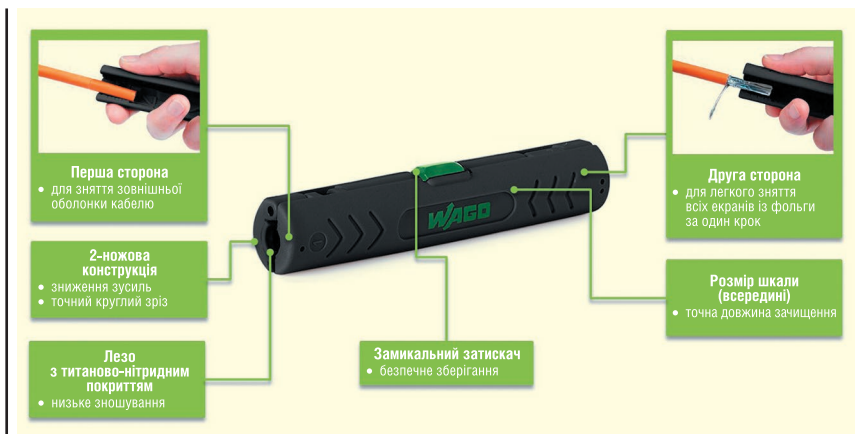
Рис. 2. Стрипер для кабелю передавання даних (206-1451); Ø 4.5–10 мм
