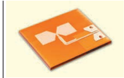
Рис. 7. 5G-антена, надрукована на замовлення на 3D-принтері компанією Nano Dimension
