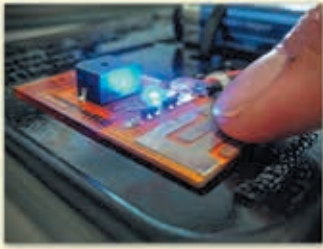
Рис. 2. Датчик дотику Phytес, надрукований на 3D-принтері DragonFly
