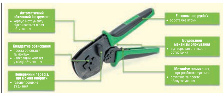
Рис. 5. Обтискний інструмент Variocrimp 16 (206-1216); 6, 10, 16 мм 2 (AWG 10, 8, 6)
