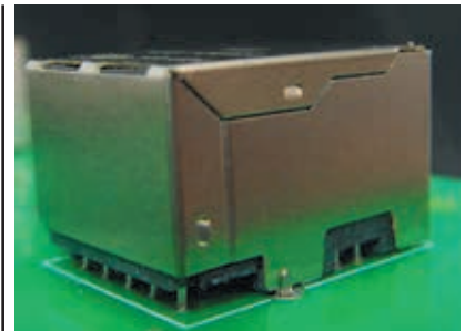
Рис. 2. Встановлення роз'єму RJ45 для технології THR із конструктивно забезпеченим збільшеним зазором
