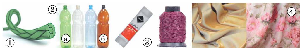
Рис. 28.4. 1. Лавсанові нитки – хірургічний шовний матеріал, що не розсмоктується. 2. Упаковка: а) для напоїв (ПЕТ); б) для харчів (композиція лавсану й алюмінієвої фольги). 3. Плетений лавсановий шнур. 4. Лавсанові тканини
