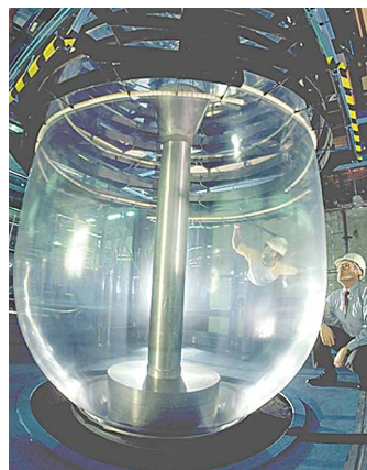
Рис. 29.2. Видувне формування поліетилену
