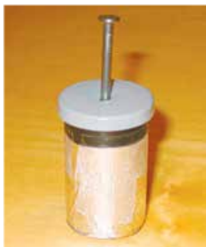
Рис. 33.2. Саморобний конденсатор (модель лейденської банки)
