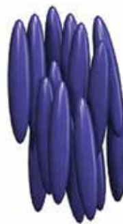
Рис. 25.3. Структура нематичного рідкого кристала
