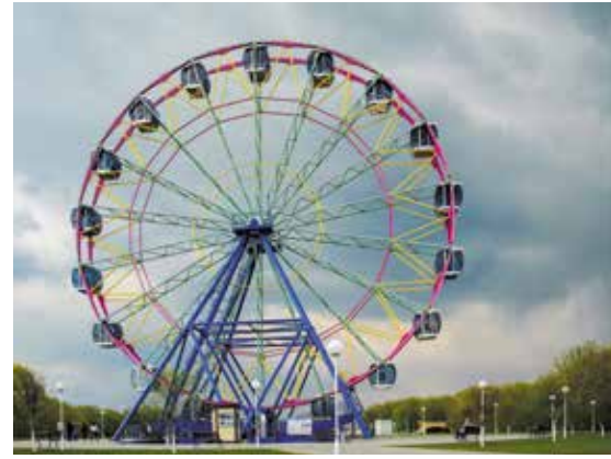
Рис. 11.1. Поступальний рух кабінок колеса огляду: кожна деталь кабінки зберігає свій напрям у просторі під час обертання колеса
