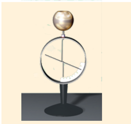
Рис. 32.4. Відхилення стрілки електрометра залежить від різниці потенціалів між стрижнем і корпусом
