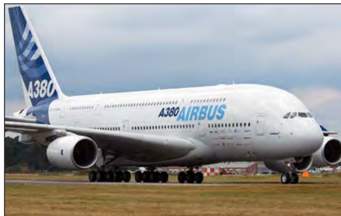
Мал. 4. Двопалубний реактивний пасажирський авіалайнер Airbus A380 — найбільший серійний літак у світі. Може здійснювати безпосадочні перельоти на відстань понад 15 тис. км.
