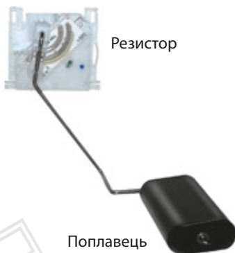
Мал. 4. Датчик рівня пального в автомобілі
