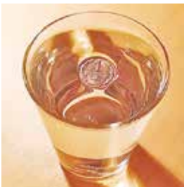
Рис. 33.4. Монетка утримується на поверхні води завдяки силі поверхневого натягу. (Щоб провести такий дослід, монетку потрібно потерти між пальців і обережно опустити на поверхню води.)
