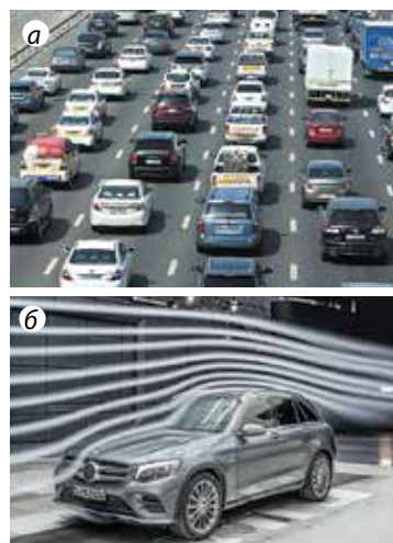
Рис. 2.1. Визначаючи швидкість і час руху автомобіля, можна застосовувати фізичну модель «матеріальна точка» (а); визначаючи аеродинамічні властивості автомобіля, цю фізичну модель застосовувати не можна (б)
