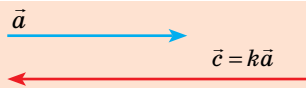
Рис. 3.5. Визначення добутку вектора \vec{a} на скаляр k : модуль вектора \vec{c} дорівнює добутку модуля скаляра і модуля вектора \vec{a} , тобто c = |k|a
