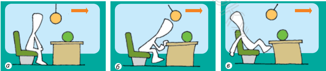
Рис. 9.3. СВ, пов'язана з потягом, буде інерціальною, тільки коли потяг відносно Землі перебуває в стані спокою або рухається рівномірно прямолінійно ( а ); в усіх інших випадках ця СВ неінерціальна ( б, в )
