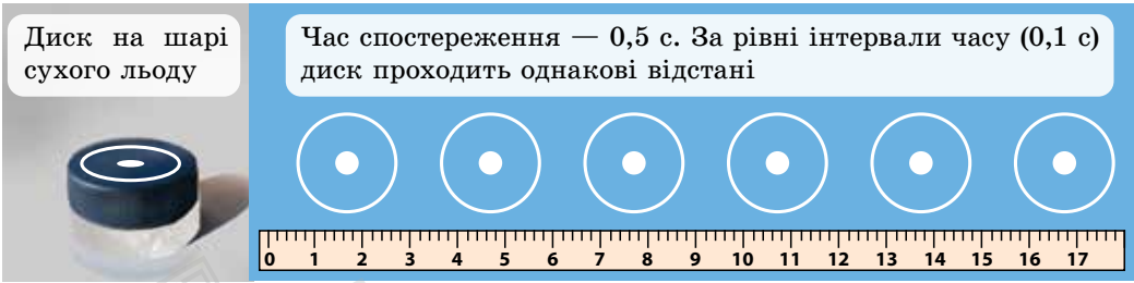
Рис. 9.2. Під час руху диска тертя майже відсутнє, тому горизонтальний рух диска наближається до руху за інерцією
