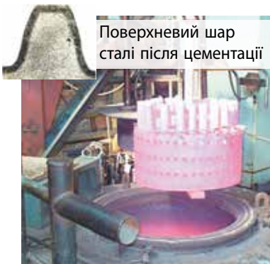
Рис. 27.4. Процес насичення поверхневого шару сталі вуглецем називають цементацією . Якщо виготовити деталь із низьковуглецевої сталі, а потім помістити її у високотемпературну суміш, яка містить вуглець, то завдяки дифузії поверхневий шар сталі збагатиться вуглецем. Отримана деталь одночасно буде твердою (зовні — міцний чавун) і не буде руйнуватися внаслідок ударних навантажень (усередині — пружна сталь)
