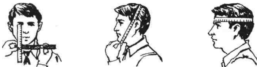
Рис. 3.3 – Заміри голови при підбиранні розміру лицьової частини протигазу: а – висота обличчя; б – вертикальний обхват; в – горизонтальний обхват
