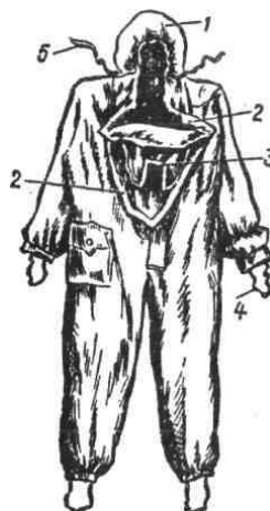
Рис. 3.12 – Комплект захисного фільтруючого одягу: 1 – капюшон; 2 – нагрудний клапан; 3 – горловий клапан; 4 – штрипки нарукавників; 5 – застібки
