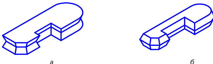
Рис. 10.6. Пример выдавливания в обе стороны симметрично относительно плоскости эскиза: а — с уклоном наружу; б — с уклоном внутрь
