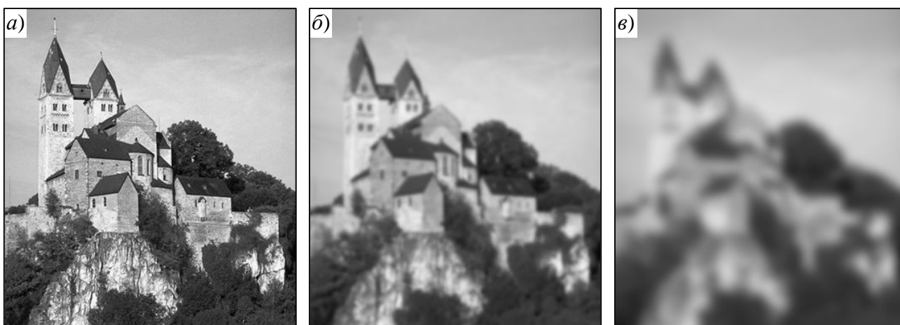
Рисунок 5.10 – Фільтр розмиття Гауса: вихідне зображення (а), \sigma = 2 (б) та \sigma = 6 (в)
