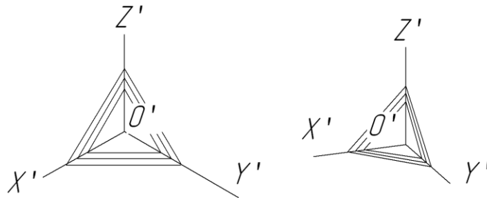
Рис. 72. Нанесення штрихування в аксонометричних проєкціях у розтинах
