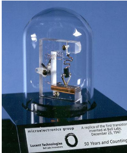
Рисунок 6 – Фото В. Браттейна, Д. Бардіна та В. Шоклі (а) та макет створеного ними точкового транзистора (б)
