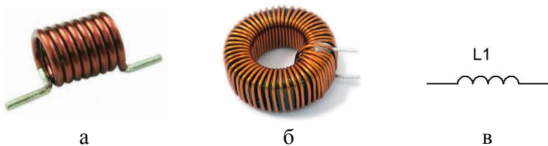
Рисунок 12 – Зовнішній вигляд котушки індуктивності без (а) та з кільцевим осердям (б) і умовне графічне позначення котушки в електричних схемах (в)
