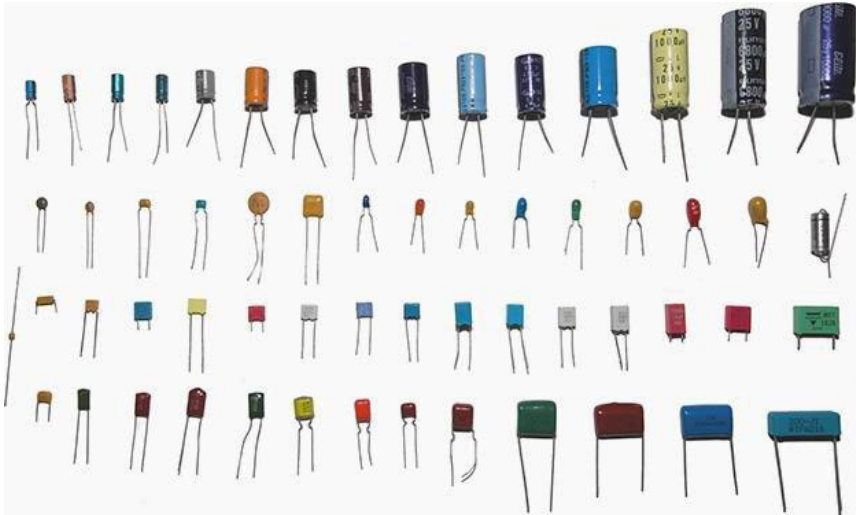
Рисунок 11 – Зовнішній вигляд конденсаторів різного типу
