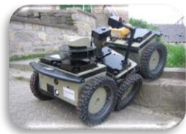
Рисунок 48 – Системи пересування роботів : а – колісна, б – крокуюча, в – рейкова
