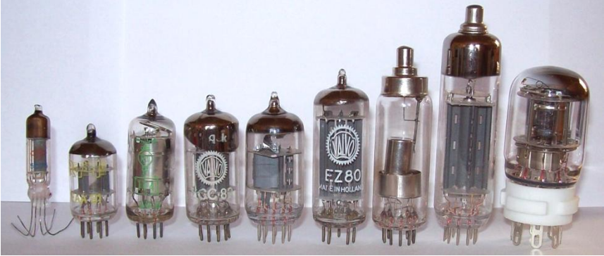
Рисунок 26 – Зовнішній вигляд електронних ламп різних типів
