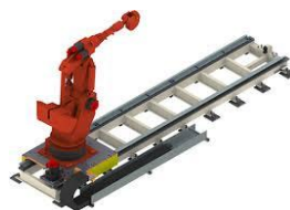
Рисунок 48 – Системи пересування роботів : а – колісна, б – крокуюча, в – рейкова
