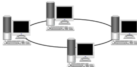
Рисунок 5.2 – Локальна мережа з кільцевою топологією
