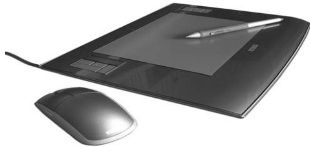
Рис. 3.18. Графічний планшет з індукційною мишкою
