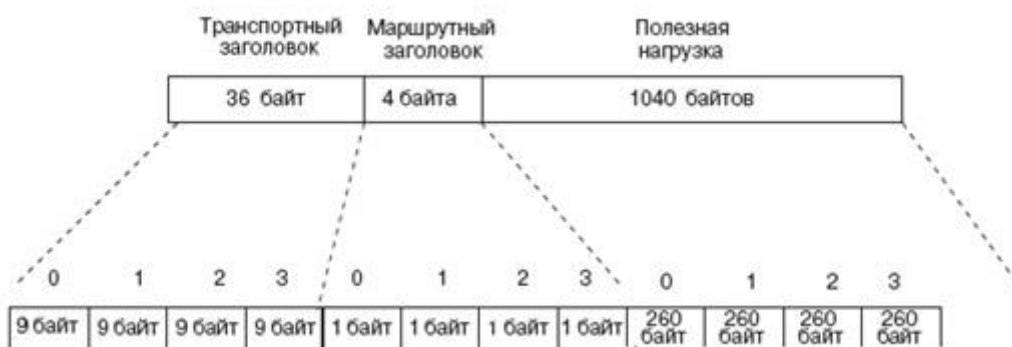
Рис. 4.6. Чергування байтів в форматі кадру синхронного транспортного модуля STM-4
