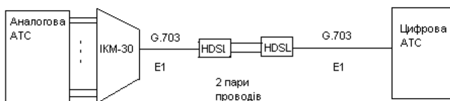
Рис. 3.10. Міжстанційний зв'язок між аналоговою і цифровою АТС
