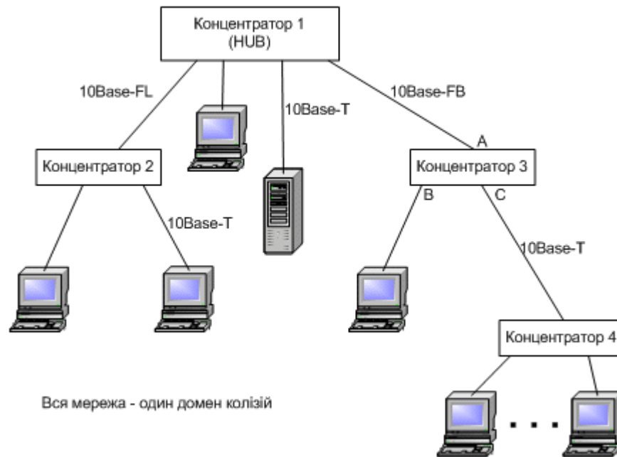
Рис. 2.9. Ієрархічне з'єднання концентраторів Ethernet
