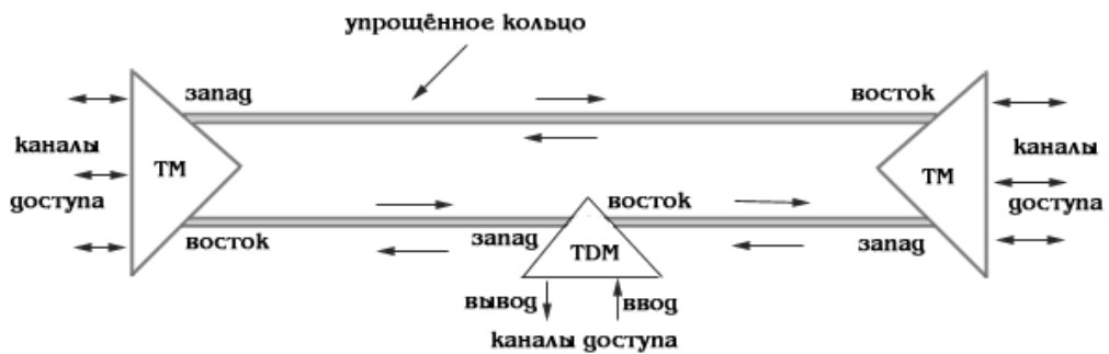
Рис. 4.11. Топологія "послідовна лінійна ланцюг" типу "спрощене кільце" із захистом 1 + 1
