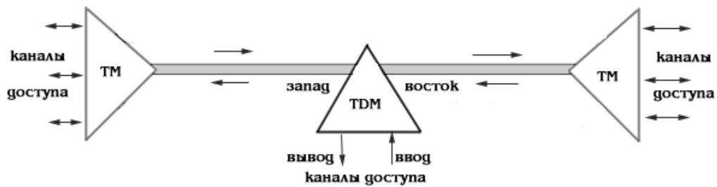
Рис. 4.10. Топологія "послідовна лінійна ланцюг", реалізована на ТМ і ТДМ
