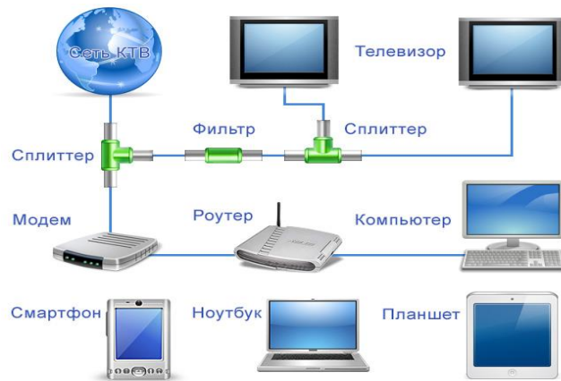
Рис. 3.14. Структура абонентської кабельної мережі
