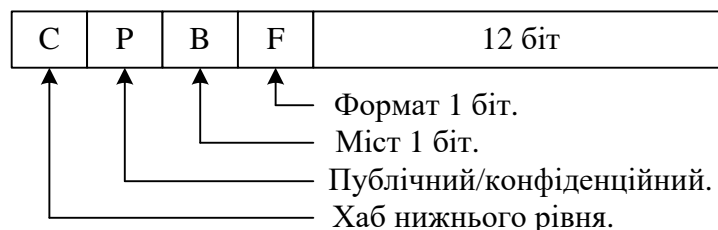
Рис. 2.33. Формат інформаційного поля кадра тестування з'єднань IEEE 802.12 (AnyLAN)
