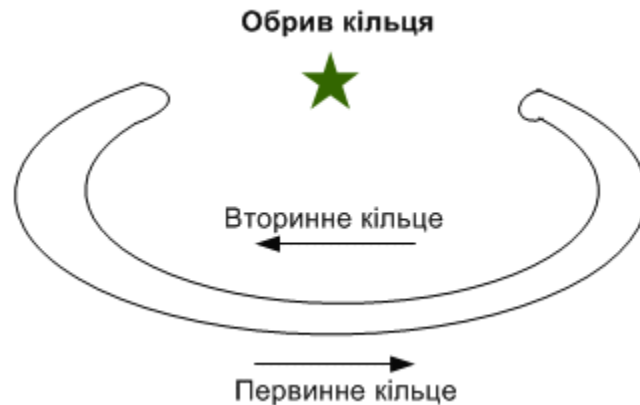
Рис. 2.36. Реконфігурація кільця FDDI при відмові
