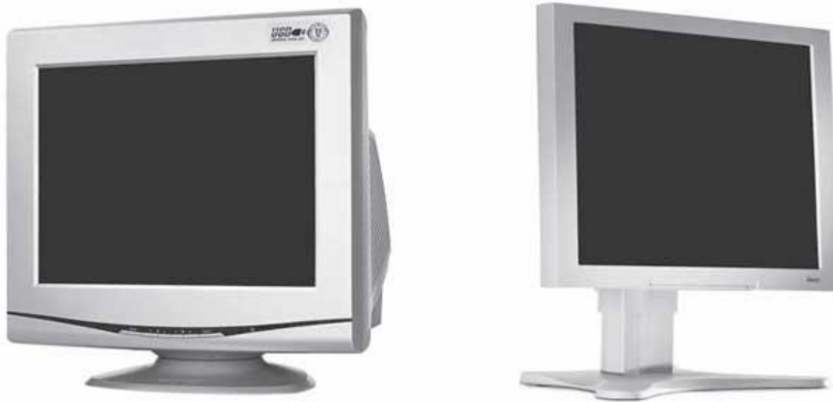
Рис. 2.1. Электронно-лучевой (слева) и жидкокристаллический (справа) мониторы
