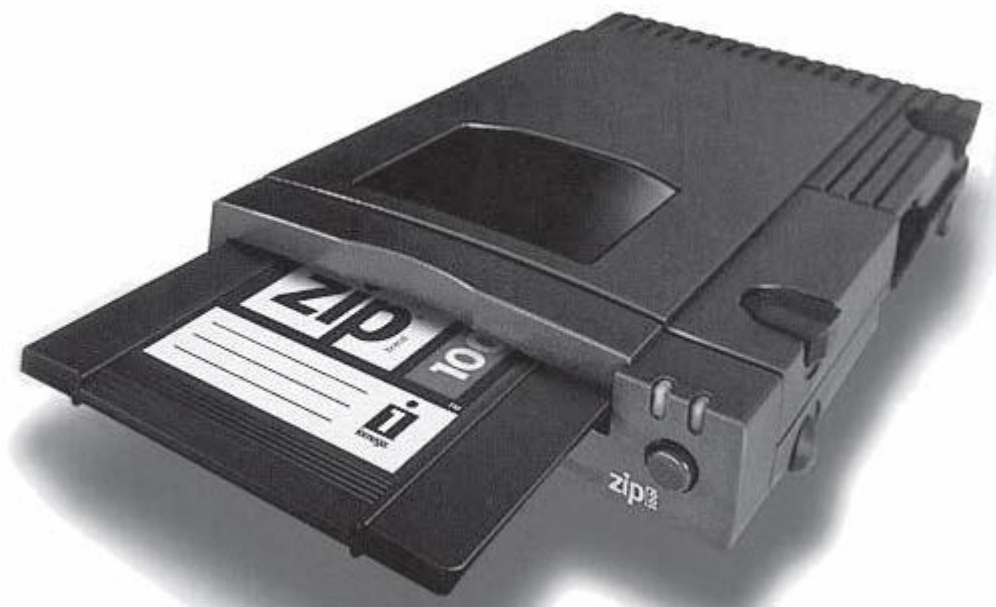
Рис. 6.4. Накопитель Zip и его привод
