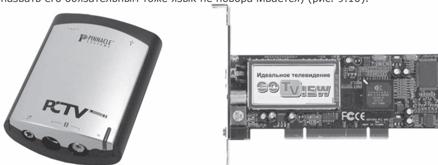
Рис. 9.10. Внешний и внутренний ТВ-тюнеры (угадайте, где какой)
