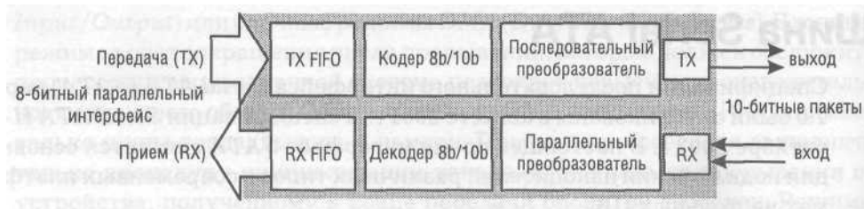
Преобразование сигналов ATA в сигналы SATA
