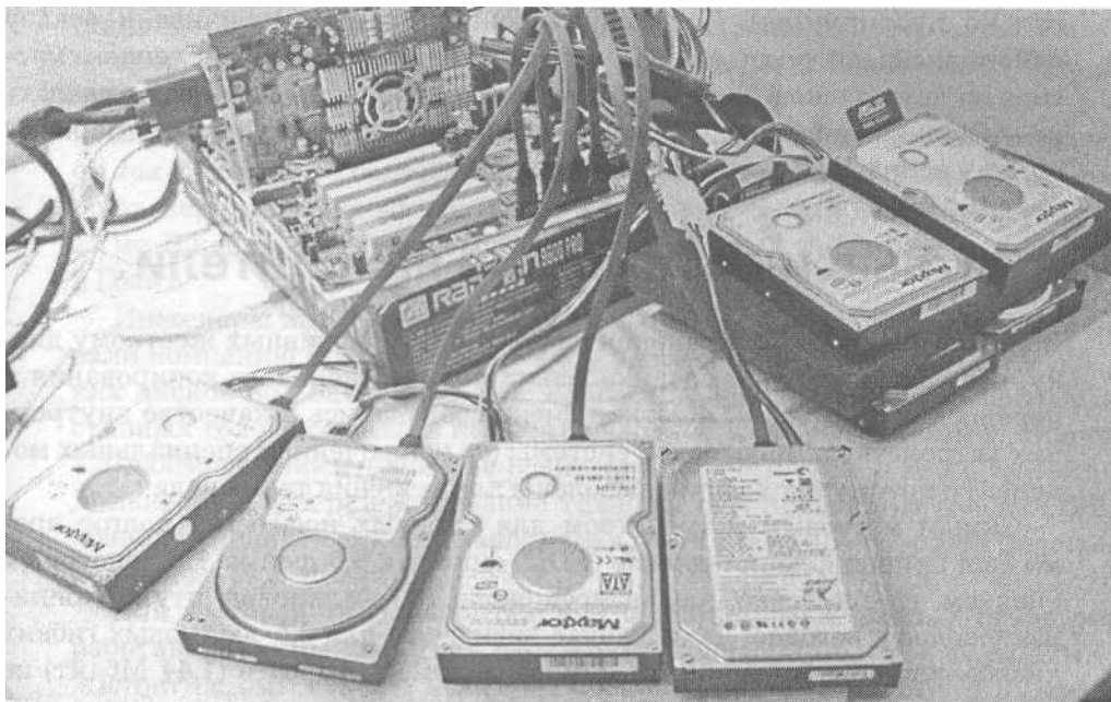
RAID-массив из 8(!) жестких дисков для домашнего компьютера
