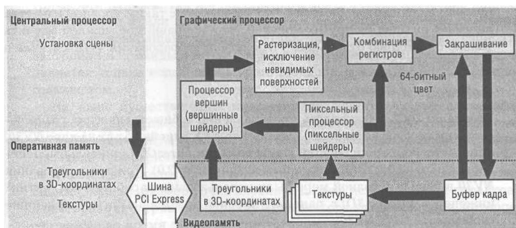
Принцип работы видеокарт поколения DirectX 9
