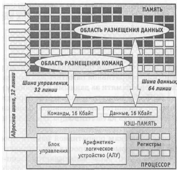
Процессор и память образуют элементарный микрокомпьютер
