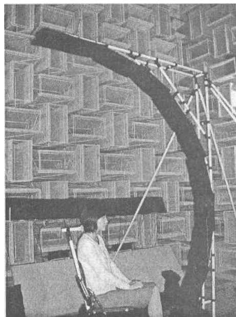
Измерение параметров HRTF в акустической лаборатории
