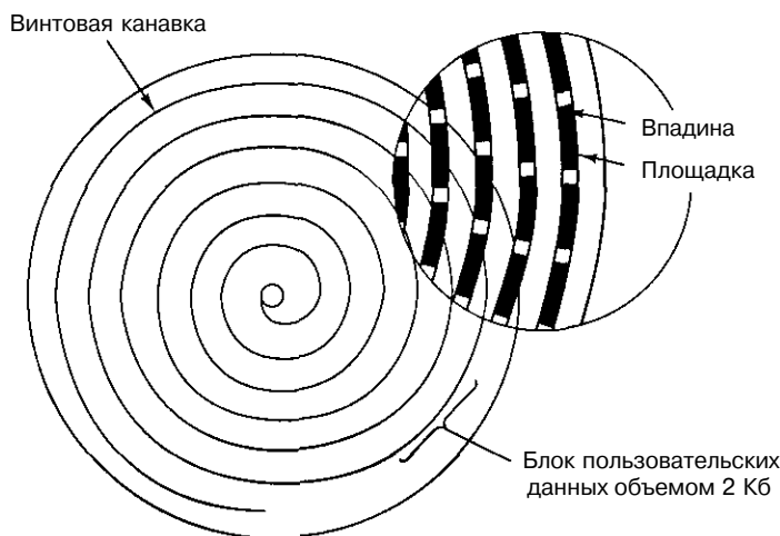
Рис. 2.19. Структура записи компакт-диска
