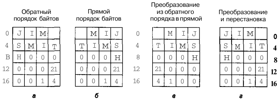
Рис. 2.10. Запись данных сотрудника для машины с нумерацией байтов слева направо (а); та же запись для машины с нумерацией байтов справа налево (б), результат преобразования записи из нумерации слева направо в нумерацию справа налево (в); результат перестановки байтов в предыдущем случае (г)
