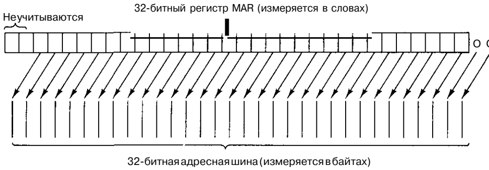
Рис. 4.3. Распределение битов регистра MAR в адресной шине
